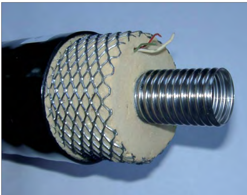
Bild 5. Flexibles Verbund-Rohrsystem mit Mediumrohr aus einem Edelstahl-Wellrohr und PIR-Hartschaumstoff als Wärmedämmung
