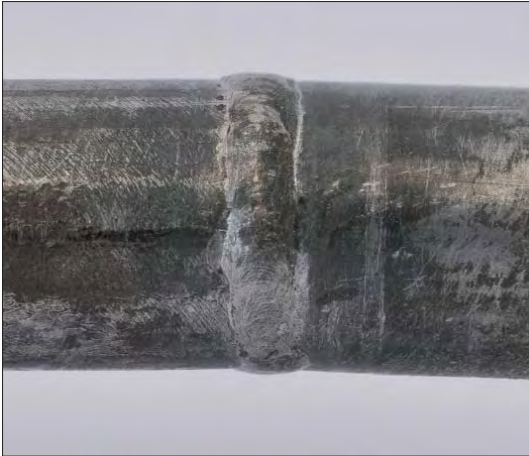
Bild 4. Werkseitig hergestellte Schweißnaht bei einem Stahlflex-Rohr
